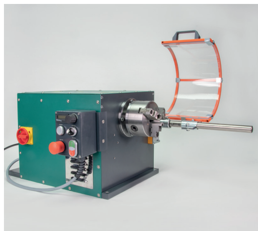
El panel de mando se puede colocar en diferentes posiciones, y la velocidad de rotación es regulable con variación continua
